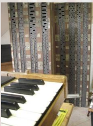
Tastatur und Windladen in der Werkstatt von Orgelbau Burkhard Klimke
