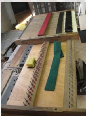
Tastatur und Windladen in der Werkstatt von Orgelbau Burkhard Klimke
