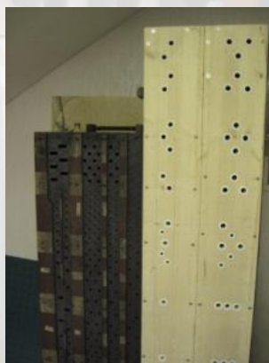
Tastatur und Windladen in der Werkstatt von Orgelbau Burkhard Klimke
